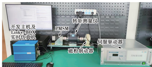
图8 PMSM 实验平台
